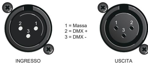
Se utilizzate i controller consigliati, potete collegare l'uscita DMX del controller direttamente all'ingresso DMX del primo apparecchio della catena DMX. Se si desidera collegare controller DMX con altre uscite XLR, è necessario utilizzare cavi adattatori.
